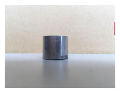
普通铝合金冷却速度慢会带来内部产生粗大的枝晶,热应力失衡。造成表面不平整,热膨胀系数大。微晶铝合金采用的是快速冷凝法,使的两种金属形成均质的合金,使晶粒越细。这样使得铝合金表面平整度高,获得更高的强度和韧性。因为是硅铝合金,更是很好的综合了两种金属的特点。高耐磨性能和精加工性能。以及低的膨胀系数。在航天领域中[RSP铝合金的 度和低膨胀系数,可以做空间设备的零部件[RSP的高平整度和易加工性,可以做反射镜。热稳定性和机械稳定性能高。可以应用在高精密工业半导体部件。
