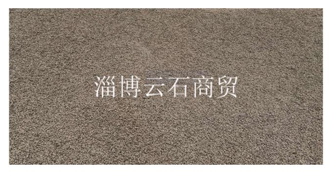
玄武岩出色的抗压抗折条件性能,而且耐磨性好,吸水率低的原因,其也是非常好的建筑装饰材料,能普遍用于室内外装饰,而且主要用作户外石材,其花色自然,能很好的和周遍景观协调,非常适合用于户外景观建设,特别是地铺石材的很好选择。不过就像前面介绍的,玄武岩易形成六方柱状节理,而且易脆,所以石材荒料普遍不大,缺乏大料。不容易生产大规格板材。玄武岩的用途十分普遍,其应用并不只局限在建筑行业中,玄武岩可以抽成玻璃丝,制作成的玄武岩玻璃丝布比一般玻璃丝布抗碱性强,耐高温性能好。玄武岩是修理公路、铁路、机场跑道所用石料中很好的材料,具有抗压性强、压碎值低、抗腐蚀性强、沥青粘附性玄武石,玄武石具有耐磨、吃水量少、导电性能差、抗压性强、压碎值低、抗腐蚀性强、沥青粘附性等优点,并被国际认可,是发展铁路运输及公路运输很好的基石。一些艺术家,根据浮石多孔和皱、漏的特点。用来建造园林中的假山,或雕成小巧玲珑的盆景。诚挚的欢迎业界新朋老友走进淄博云石商贸有限公司!张店区路面用玄武岩石子厂
