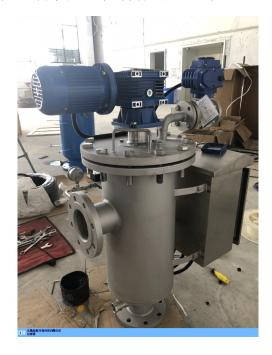
◆过滤设备控制系统反应灵敏,运行精确,可以根据不同水源和过滤精度灵活调整反冲洗压差时间和时间设定 值。
